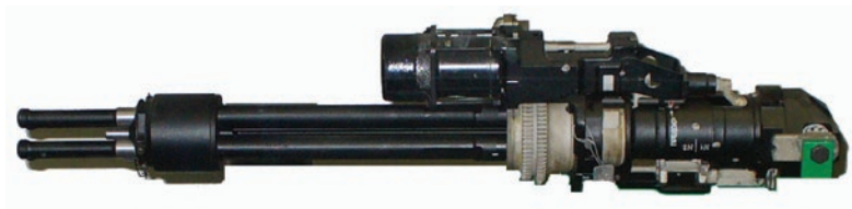
Ил. 10. 7,62-мм авиационный пулемет ТКБ-621 (ГШГ-7,62)
