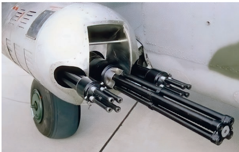
Ил. 11. С. 523. Вертолетная подвесная установка (гондола) ГУВ-8700 с установленными в ней 12,7 и 7,62-мм пулеметами ЯкБ-12,7 и ГШГ-7,62
