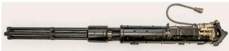
Ил. 8. 12,7-мм авиационный пулемет ТКБ-063 (ЯкБ-12,7). Фото ЦКИБ СОО
