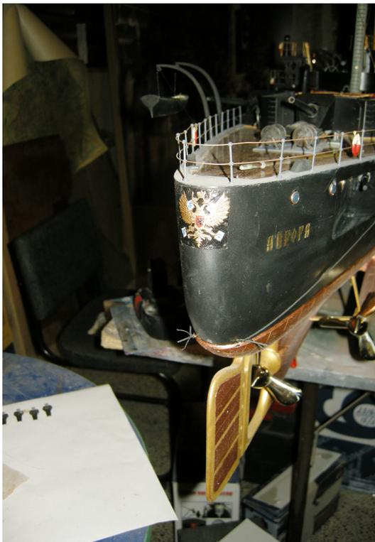
Ил. 6. Кормовая оконечность корпуса с изготовленным гербом
