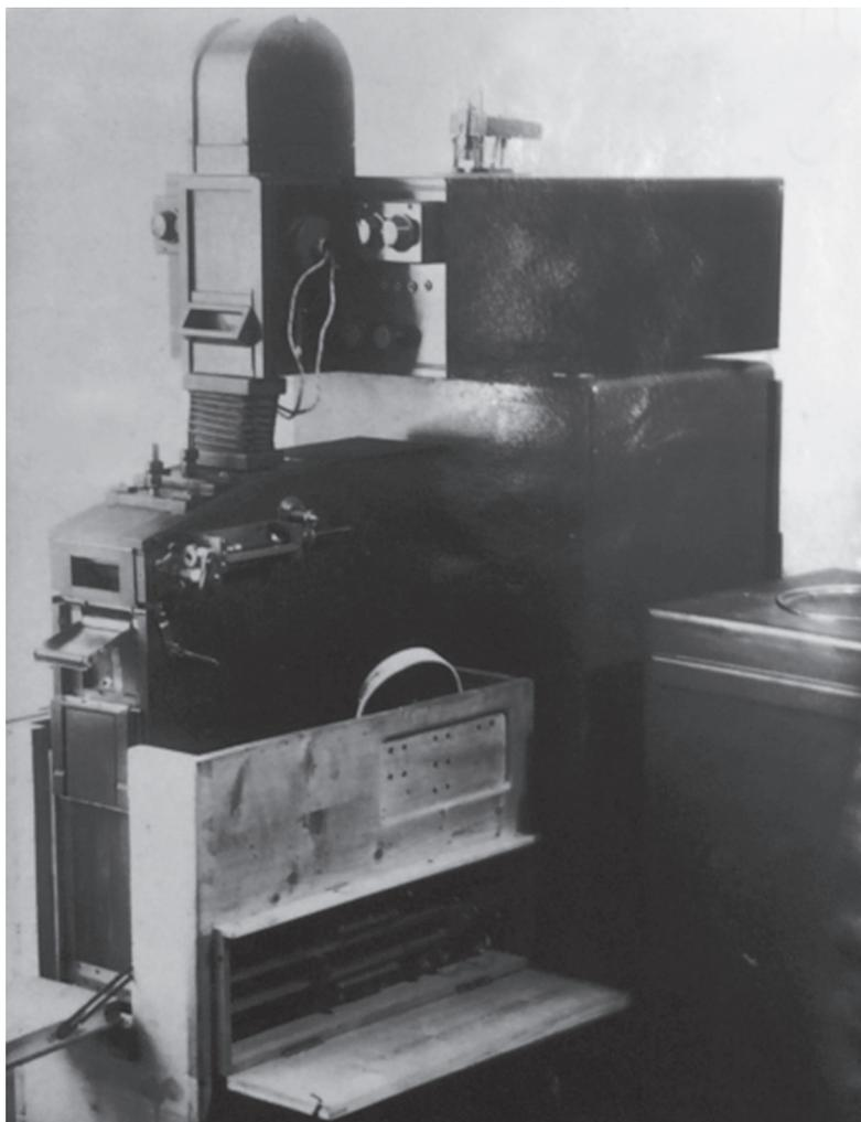
Ил. 6. Осциллографическая станция с фотозаписью системы Бенуа
