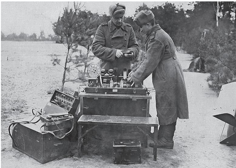
Ил. 10. Развертывание звукометрической станции СЧЗМ-36 для боевой работы. Ленинградский фронт. 1943 г.
