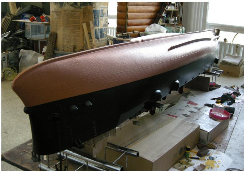
Ил. 4. Имитация медной обшивки подводной части корпуса
