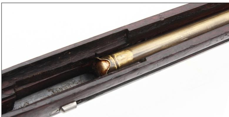
**Рис. 2. Вид на подствольный магазин в разобранной винтовке**
