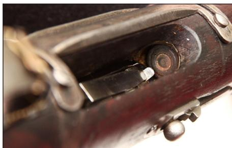
**Рис. 6. Защелка на конце рычага подавателя**
