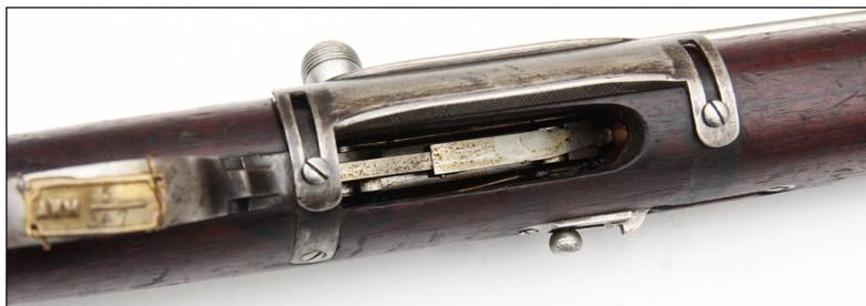
**Рис. 4 Крышка окна заряжания в закрытом состоянии**
