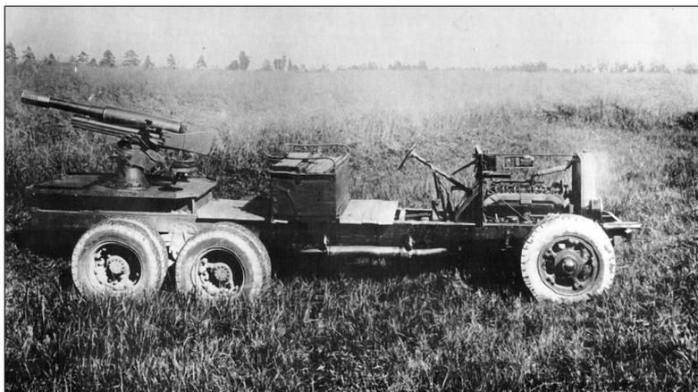
**Рис. 2. Самоходная установка 76-мм полковой пушки обр. 1927 г. на шасси автомобиля «Мореленд»**
