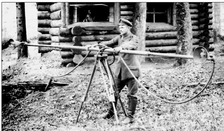
Рис. 8. Прибор для засечки стреляющего орудия. Германия, 1916 г.
