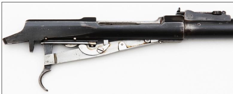
запирались с помощью специальной задвижки. После этого винтовка могла заряжаться одиночными патронами как обычная винтовка обр.1870 г. – через окно ствольной коробки.
