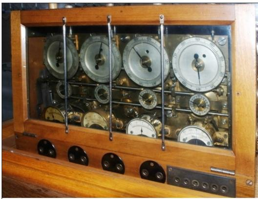
**Рис. 4. Регистрирующий прибор звукометрической станции Бенуа**
