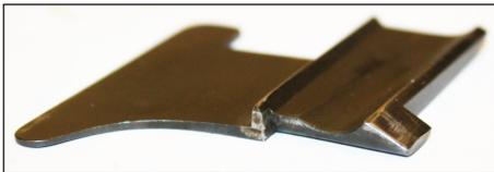
**Рис. 5. Отсечка патронов винтовки Нагана**
