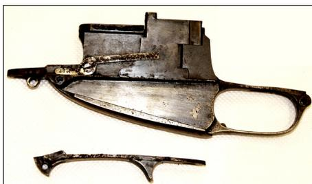
Рис. 2. Магазинная коробка со спусковой скобой и хвостовик спусковой скобы винтовки Нагана
