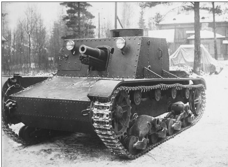
**Рис. 6. Самоходная установка 76-мм полковой пушки обр. 1927 г. с укороченным откатом – СУ-1**
