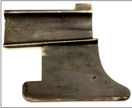
**Рис. 4. Отсечка патронов винтовки Нагана**
