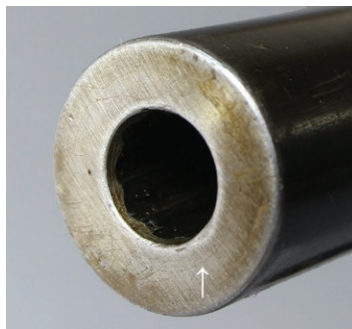
Ил. 15. Крупный вид на дульный срез ствола; стрелкой указана граница лейнера, ВИМАИВиВС 100Ф 5/265
