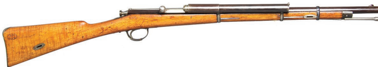
Ил. 2. Карабин обр. 1870 г. с ускорителем заряжания конструкции Вольфа ёмкостью на три патрона, опытная модель 1872 г., зав. № 23, общий вид. ВИМАИВиВС 100Ф 5/261
