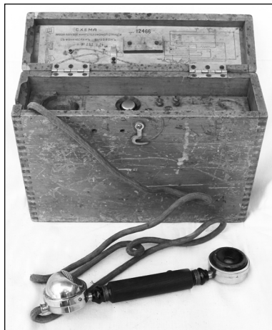
Аппарат телефонный, с фоническим вызовом. Изготовлен в 1916 г.
