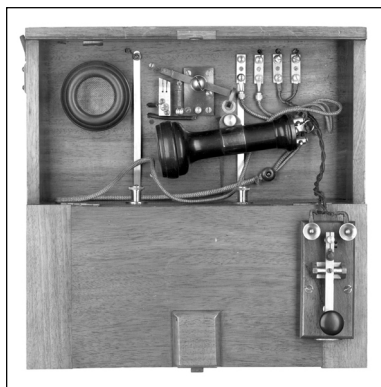
Рис. 5. Военно-полевой телефонный аппарат с телеграфным ключом английского производства. Начало XX вв.
