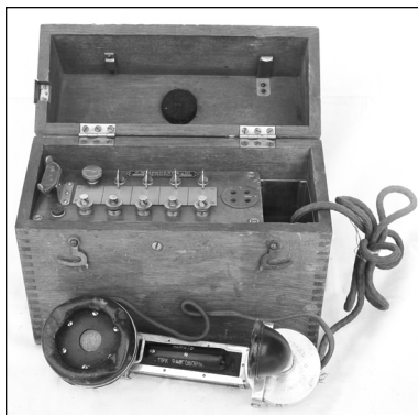
Аппарат телефонный, с фоническим вызовом типа «Ордонанс». Изготовлен в 1915 г.
