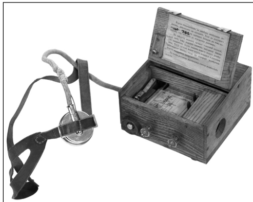
Рис. 3. Малогабаритный военно-полевой телефонный аппарат разведчика системы Шателена санкт-петербургского завода акционерного общества русских электротехнических заводов «Сименс и Гальске». 1912 г.
