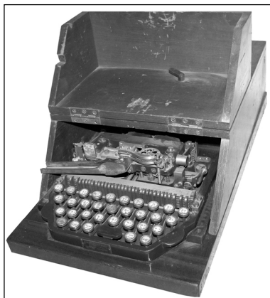
Рис. 10. Клавиатурный перфоратор буквопечатающего телеграфного аппарата Муррея петроградского телефонно-телеграфного завода «Н.К. Гейслер и К°». 1910-е гг.
