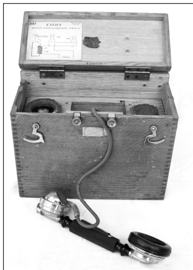
Станция минная, микротелефонная. Изготовлена в 1916 г.
