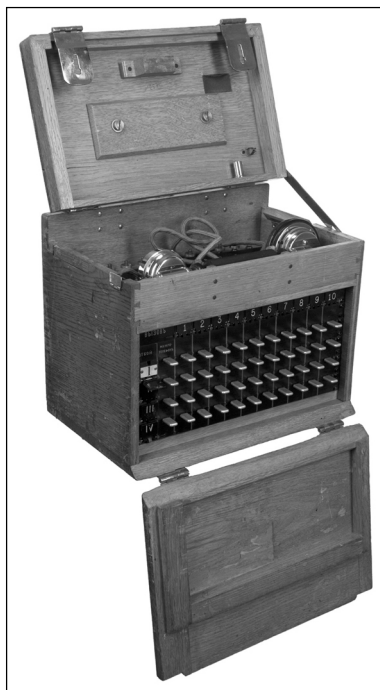
Рис. 7. Военно-полевой телефонный коммутатор на 10 номеров петроградского телефонно-телеграфного завода «Н.К. Гейслер и К о ». 1915 г.
