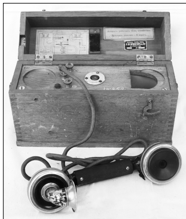
Аппарат телефонный, магнито-электрический «БИ-ТЕЛЕФОН». Изготовлен в 1916 г.
