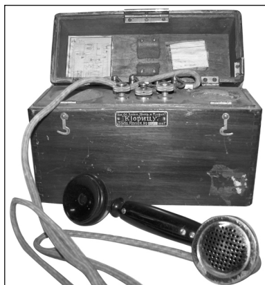
Рис. 6. Военно-полевой телефонный аппарат токийского акционерного общества электрических инструментов и проводов «Кюрицу». 1916 г.
