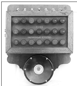
Коммутатор фонический, кнопочный на 6 линий. Изготовлен в 1915 г.
