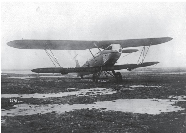
Ил. 1. Общий вид 6-орудийной 132-мм установки на самолете Р-5. Агрегаты по 3 орудия в каждом подвешены под нижними крыльями
