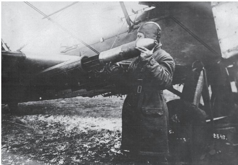
Ил. 2. 3-орудийный агрегат на самолете P-5. Заряжение орудия
