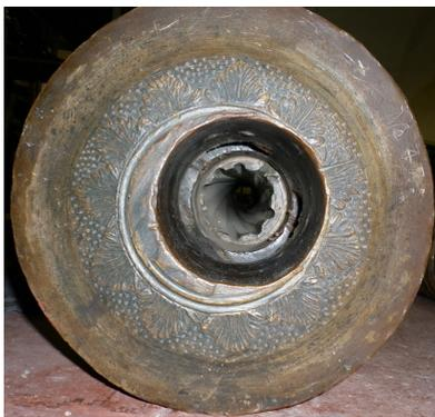
Ил. 4. Торель и зарядная камера (ВИМАИВiBC MЧA 9/59)
