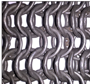
Рис. 2. Плетение колец в кольчужной шестерне
