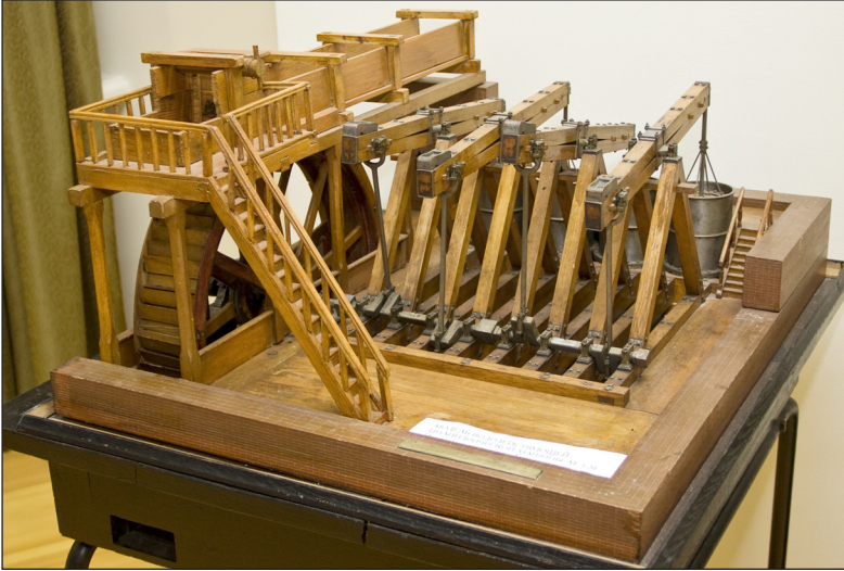
Рис. 1. Действующий макет вододействующей цилиндрической воздуходувной машины. Автор И. Трипецкий. 1834 г. Александровский завод, г. Петрозаводск
