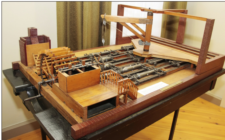
Рис. 2. Действующий макет пушечно-сверлильного цеха Александровского завода. Автор И. Трипецкий. 1834 г. Александровский завод, г. Петрозаводск
