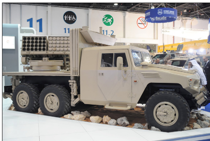
Рис. 10. Вариант БМ для ТРС калибра 107 мм для ОАЭ (Сербия)
