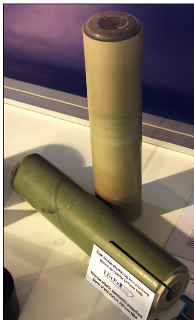
Рис. 9. Заряд термопластичного смесового топлива ТРС М06 (возможно, макет) (Сербия, 04.06.2009 г.). Фото: ©Miroslav Györfösi (Словакия)
